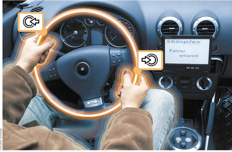
Die Finger am Lenkrad identifizieren den Fahrer. Bei der neuen Sensor-Technik werden die Signale über die Oberflächenspannung der Haut übertragen.
