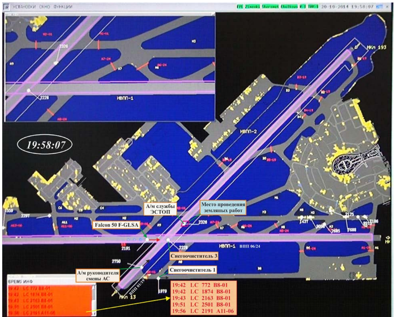
Рисунок 19. Вид индикатора TRADIS на РМ СДП УВ перед АП
