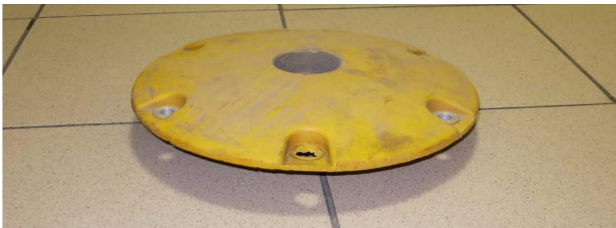
Рисунок 58. Фрагмент фонаря (основание) ССО
