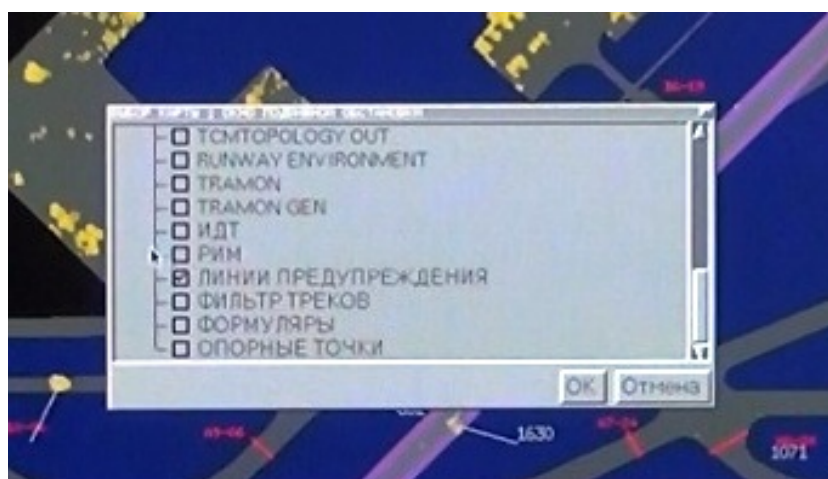
Рисунок 22. Статус технической карты с линиями предупреждения на рабочем месте РПА. Карта активирована (отмечена галочкой)
