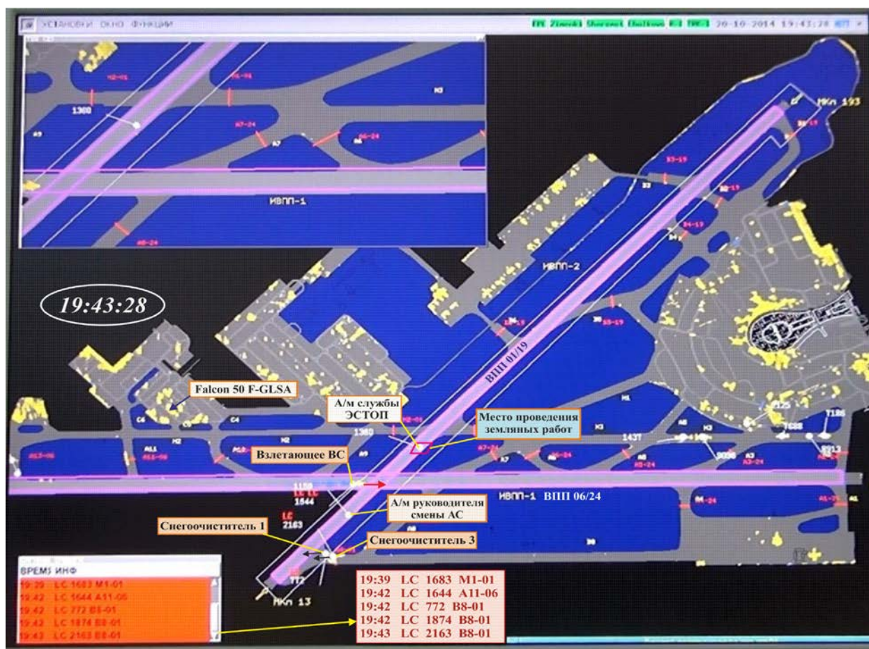
Рисунок 94. Индикатор TRADIS на РМ диспетчера СДП в 19:43:28 (светло-красное табло показывает информацию в табло тревог)
