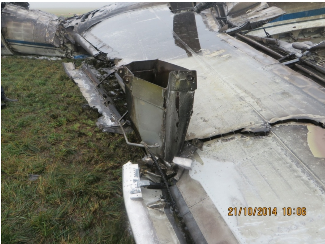
Рисунок 39. Правая консоль крыла с элементом снегоуборочной машины
