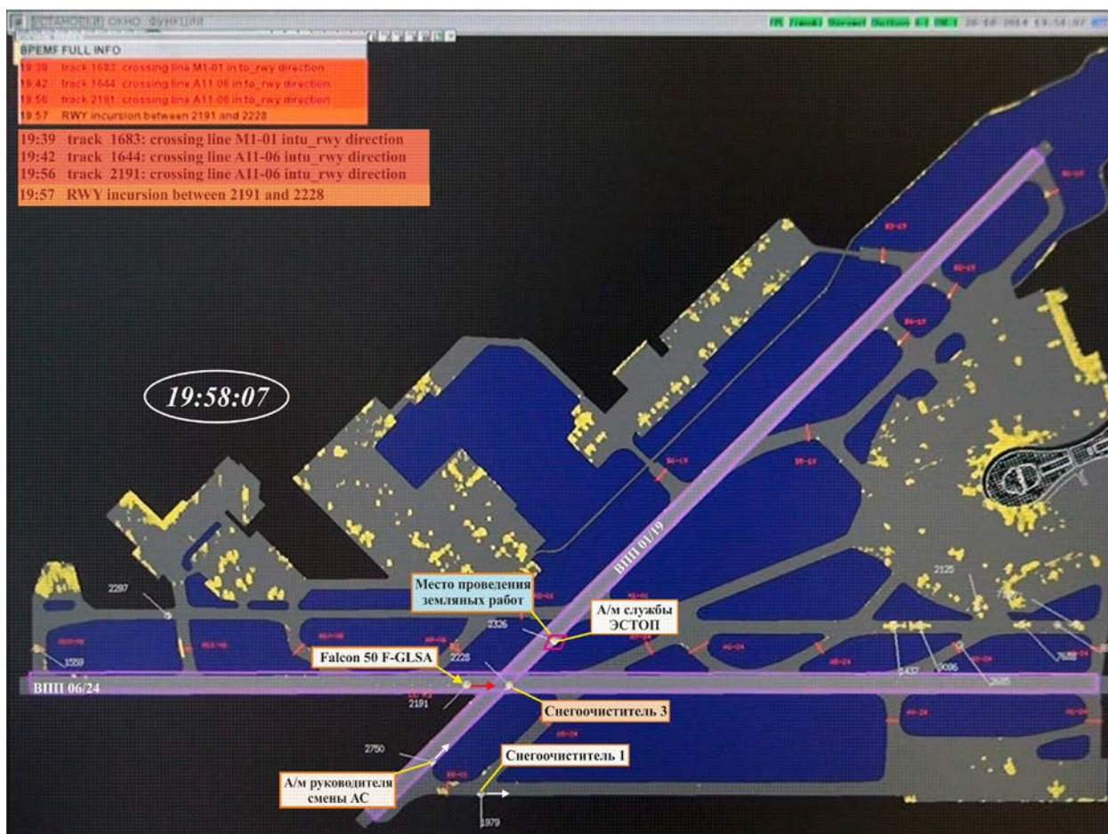
Рисунок 24. Вид индикатора TRADIS на РМ РПА перед АП
