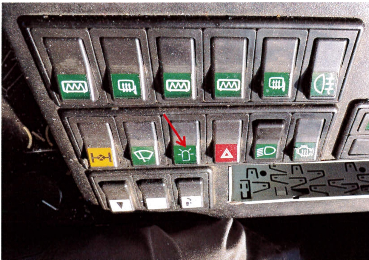
Рисунок 53. Клавиша включения проблесковых маячков (показана стрелкой) на панели управления в кабине SCHMIDT SUPRA-5001 г/н 377
