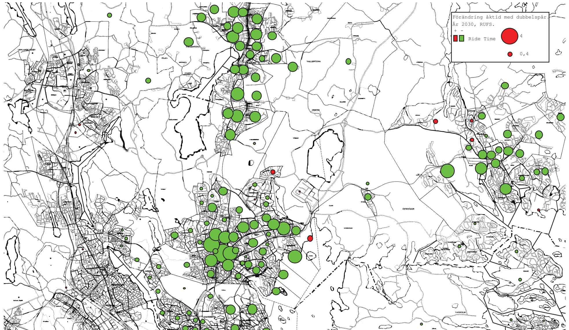
Figur 4.7. Genomsnittlig förändring på åktiden år 2030 per område efter dubbelspårsutbyggnaden på Roslagsbanan. Rött innebär längre upplevd restid, grönt innebär kortare upplevd restid.
