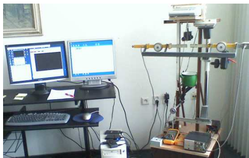
Vzhled měřicí aparatury ke sledování šíření vlhkosti ve stavebních hmotách
