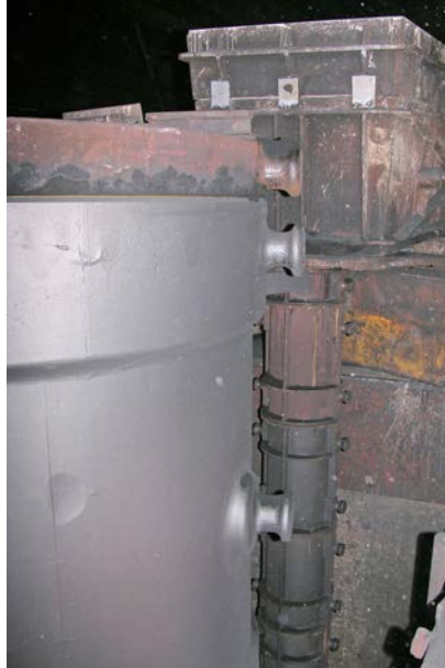
Bild 6: Giessaufbau beim CASTOR®-Abguss (Giessback – Fallrohr - Kokille)
