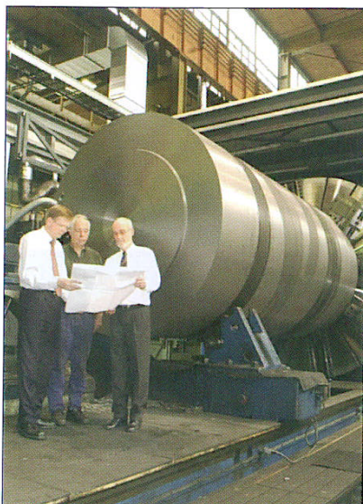
Bild 9: Mechanische Bearbeitung auf der Großdrehmaschine
