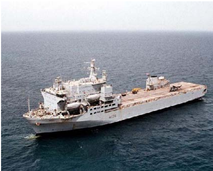
RFA "Argus", ex "Contaneder Besan", transformado mediante SCADS-C (Después se le efectuaron más modificaciones cuando fue comprado por el gobierno británico).
