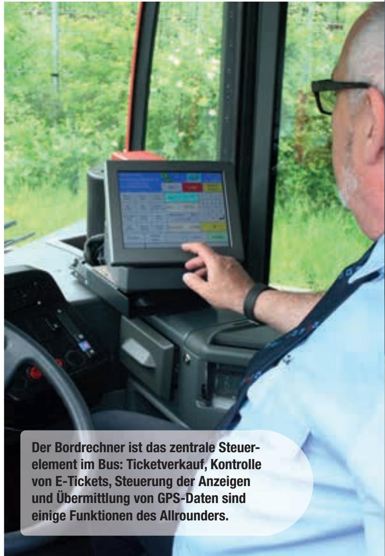
**Der Bordrechner ist das zentrale Steuerungselement im Bus: Ticketverkauf, Kontrolle von E-Tickets, Steuerung der Anzeigen und Übermittlung von GPS-Daten sind einige Funktionen des Allrounders.**
