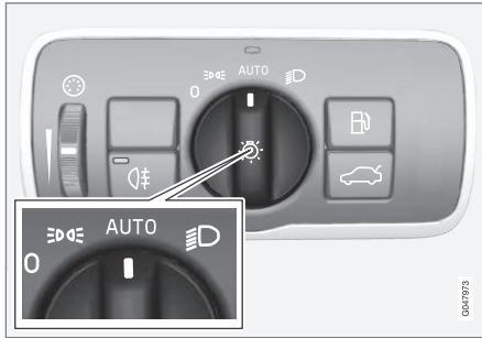
Drehregler des Lichtschalters in Stellung AUTO .
