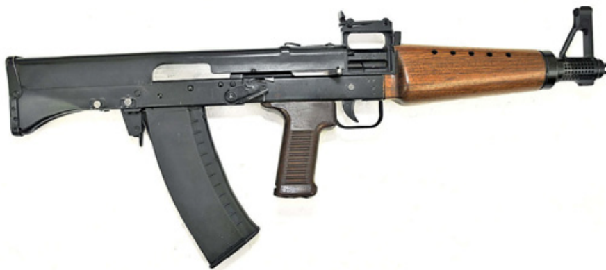
5,45-мм автомат АЛ-2 конструкции Ю.К. Александрова и Р.С. Поваренкина, экспериментальный образец 1960-70-х гг. «Ижмаш». Вместимость магазина 30 патронов, прицельная дальность 1000 м
