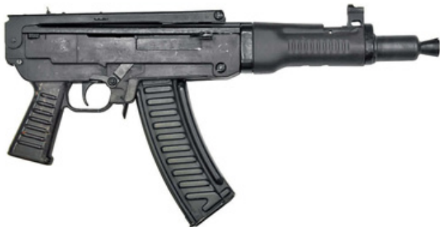
5,45-мм автомат МА конструкции Е.Ф. Драгунова, экспериментальный образец 1977-78 гг. «Ижмаш». Вместимость магазина 30 патронов, прицельная дальность 500 м
