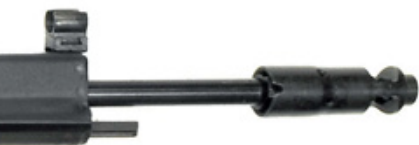
5,45-мм автомат АС конструкции Г.Н. Никонова, опытный образец 1984 г. «Ижмаш». Вместимость магазина 30 патронов, прицельная дальность 1000 м, масса 3,18 кг, темп стрельбы 600/1800 выстр./мин
