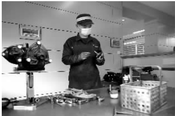
周元强 刹车总成装配员 工作13年 负责将更换下来的刹车总成拆解修理后重新组装。
