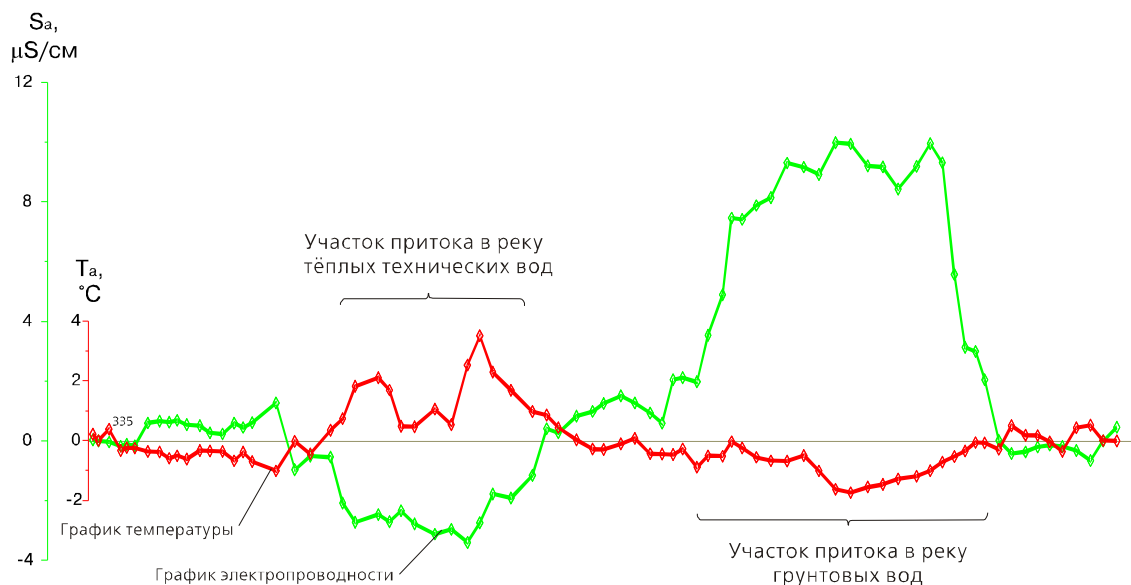
Рис. 3. Прибрежная часть р. Волги в районе г. Ярославля. Графики резистивиметрии и термометрии в районе нефтеналивных терминалов
