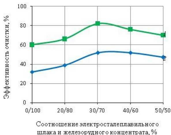
Рис. 3. Влияние магнитного поля на отработанную СОЖ 1 – в условиях магнитной обработки; 2 – в условиях без магнитной обработки
