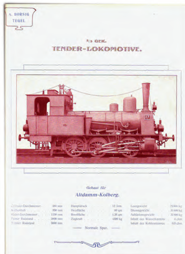
Modelo de locomotora similar a las utilizadas en el Ferrocarril de General Cruz a Pemuco y Cordillera, (modelo 1907) con sus características técnicas generales (1904). (Archivo familia Sandoval Stevens.)
