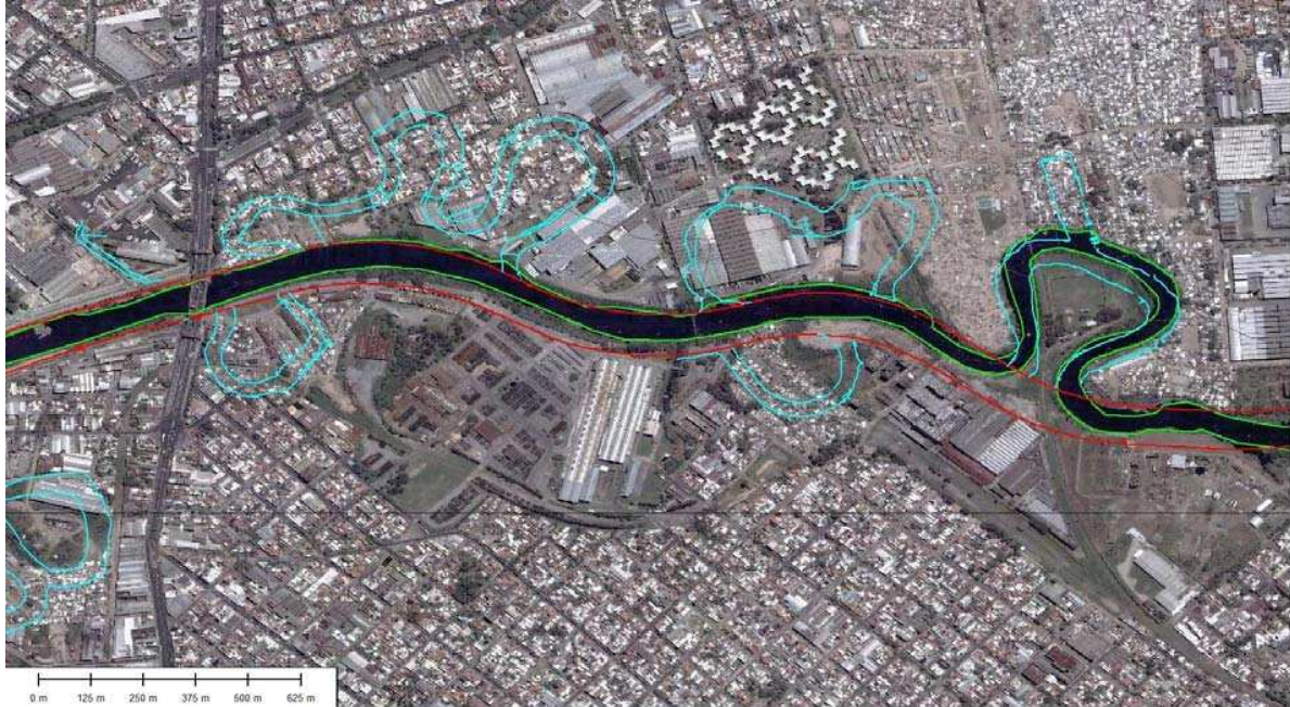
Figura 2. 17 Rectificaciones proyectadas (rojo), ejecutada (verde). Único meandro remanente en el sector.
