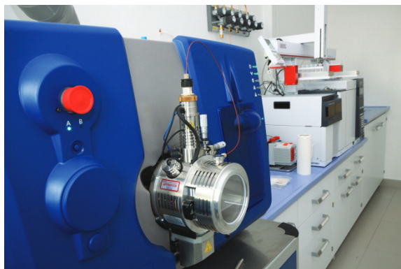
Slika 5: LC-Qtrap tekočinski kromatograf s hibridnim masnim spektrometrom za analizo polarnih organskih spojin Instrument je sestavljen iz tekočinske kromatografije, VIS detektorja, ionske izvira SI in I ter tandemske masne spektrometra
