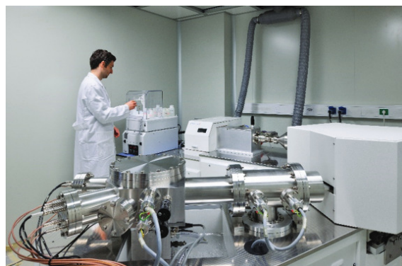
Slika 8: Nu Instruments - Multikolektorski - ICP-MS je namenjen določitvi izotopske sestave težjih elementov
