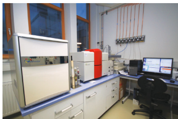
Slika 9: IsoPrime 100 - Vario PYRO Cube (OH/CNS Pyrolyser/Elemental Analyser). Masni spektrometri ter z elementnim analizatorjem in pirolizo za analizo stabilnih izotopov v trdnih in tekočih vzorcih
