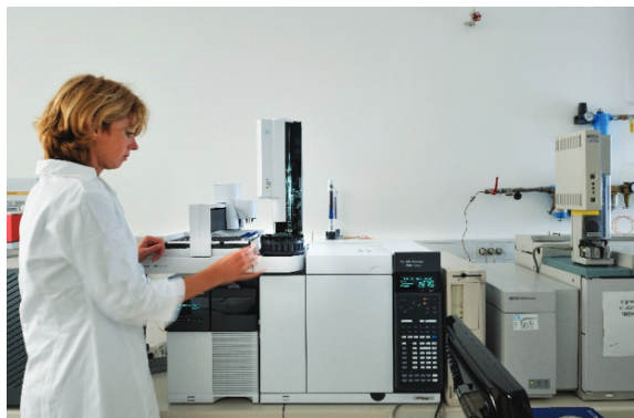
Slika 6: GC-MSD plinski kromatograf z masno-selektivnim detektorjem za analizo organskih onesnažil
