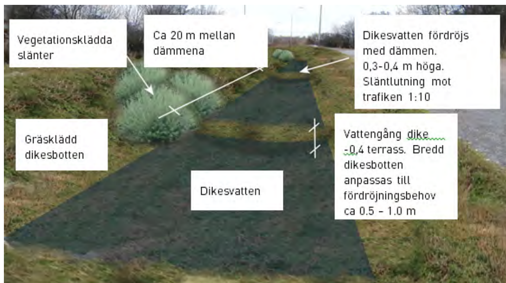
Figur 19. Särskilt utformade infiltrationsdiken för rening och fördröjning av vägdagvatten.
