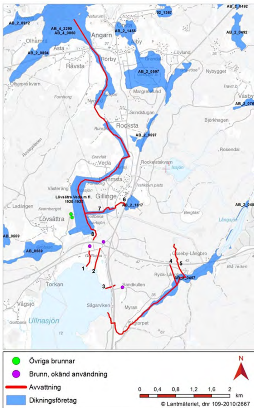
Figur 6. Avvattningspunkter till Ullnasjön och Angarnssjöängen. Nummer 1-5: avvattnas mot Ullnasjön. Nummer 6-8: avvattnas mot Angarnssjöängen.
