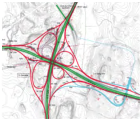
Figur 11. Alternativ utformning av fullt utbyggd trafikplats enligt förstudiens alternativ 5. Gröna linjer är E18, väg 276 och väg 975. Röda linjer är nya delar i Tpl Rosenkälla och blåa linjer är vägdelar som hör till nya Tpl Handel.
