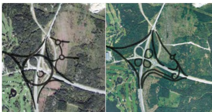
Figur 10. Alternativa utformningar av trafikplats Rosenkälla och anslutning till handelsplats. Principskisser från projektets förstudie.
