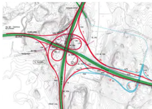
Figur 11. Alternativ utformning av fullt utbyggd trafikplats enligt förstudiens alternativ 5. Gröna linjer är E18, väg 276 och väg 975. Röda linjer är nya delar i Tpl Rosenkälla och blåa linjer är vägdelar som hör till nya Tpl Handel.
