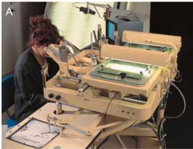
Fig. 7. Fotogrammetriske udtegningsinstrumenter ved GEUS's flyfotolaboratorium.
