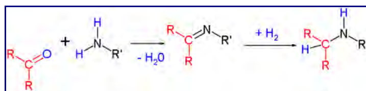
Obr. 3 Schématické znázornenie konverzie karbonylovej skupiny sacharidu na amíny na imínový medziprodukt
