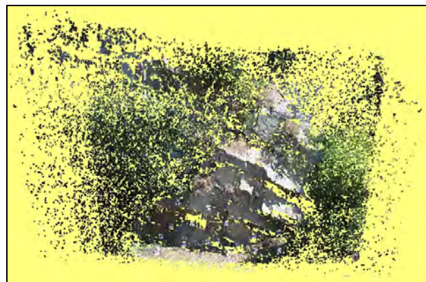
Obr. 5 Mračno 3D bodov – Devínska cesta, ohnisková vzdialenosť 35 mm
