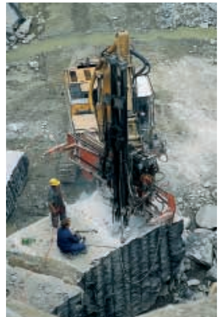
Abb. 3: Herstellung gattergerechter Granitblöcke im Steinbruch Eitzing, Bayerischer Wald
