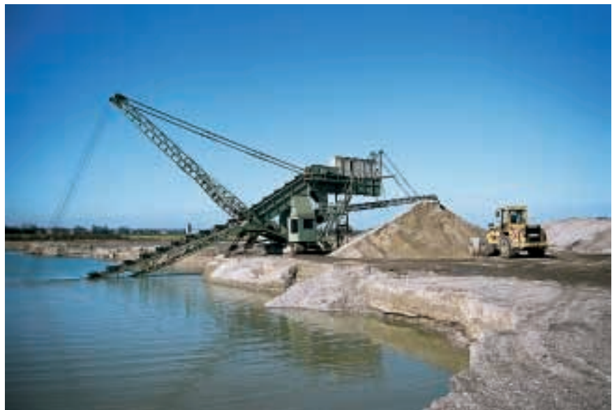
Abb. 12: Nassabbau von Niederterrassenkies bei Derching, nordöstlich Augsburg
