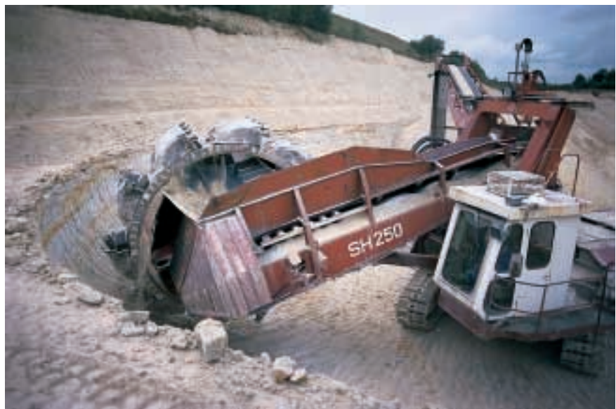
Abb. 18: Abbau von Kaolin durch Schaufelradbagger, Hirschau, Oberpfalz
