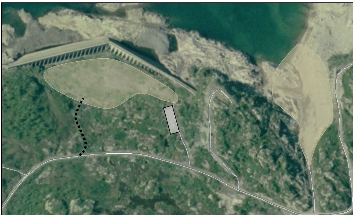
Figur 3.7 Foreslåtte tippområder og rigg (grå skravur). Hvite streker er eksisterende veger. Stiplet svart strek er foreslått anleggsveg. Boligrigg er foreslått i lysegrått område.
