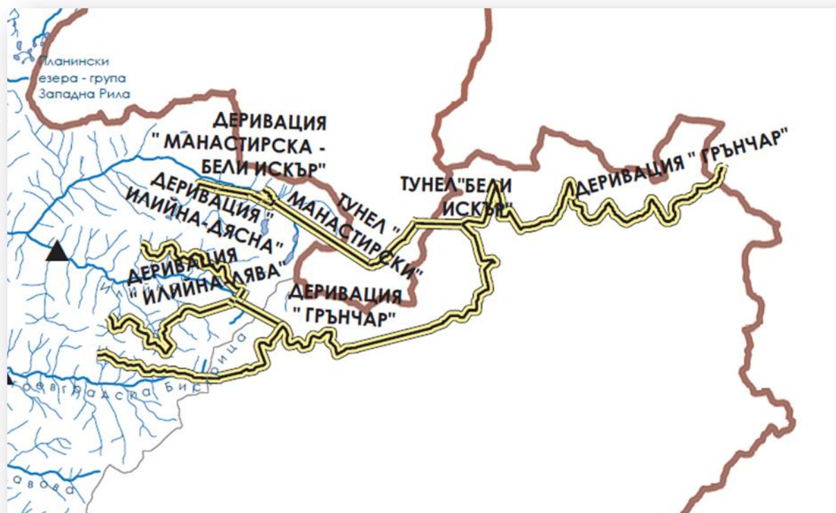
Фиг. 1.10-7. Прехвърляне на води от поречието на р. Струма (информация, БДЗБР)
