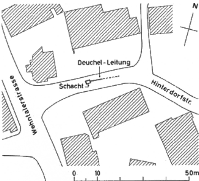
Dielsdorf. Hinterdorfstrasse. Fund einer Deuchelleitung, 1964.
