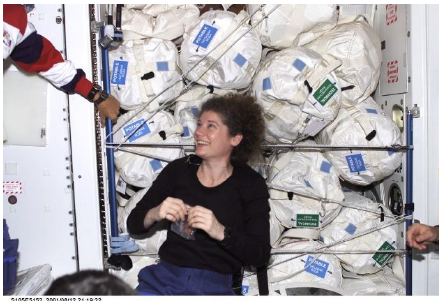
図4.1-6 米国の水容器(CWC) (NASA) (表面が布地のソフトタイプの容器)
