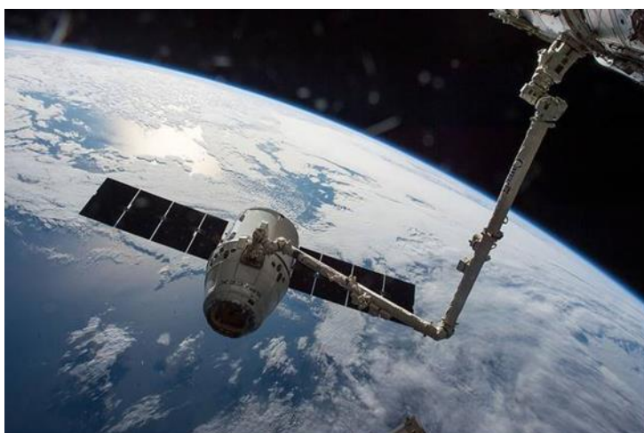
図4.3-2 ロボットアームで把持されたSpace X社のドラゴン補給船 (SpX-8)(NASA)
