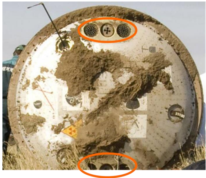
図2.11-2 ソーズTMA-11の衝撃緩和用ロケット (NASA HPより)
