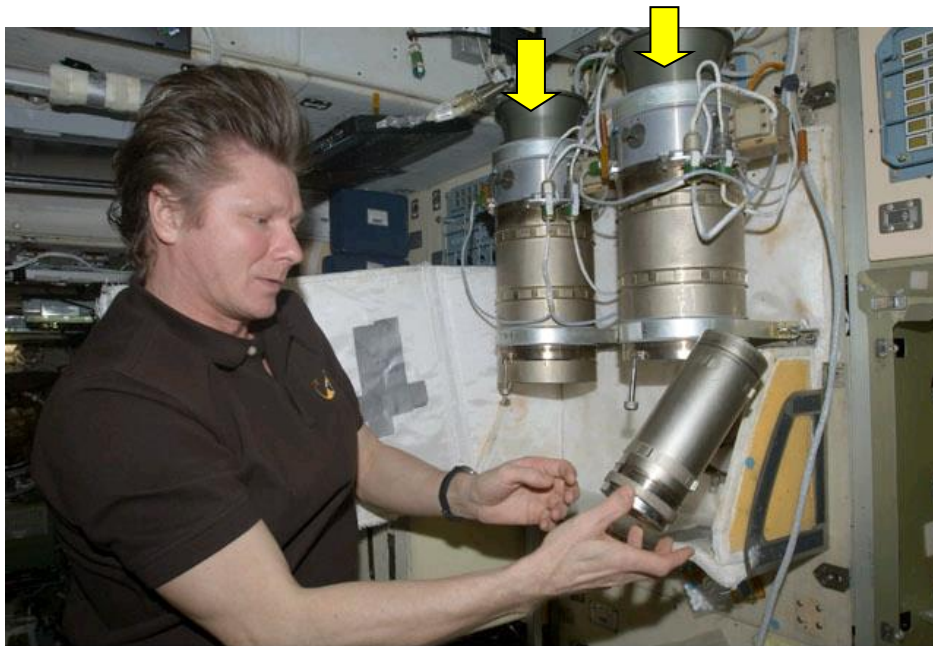
図4.2-3 ズヴェズダ内に設置されているSF6O2容器2本 (矢印) (NASA)
