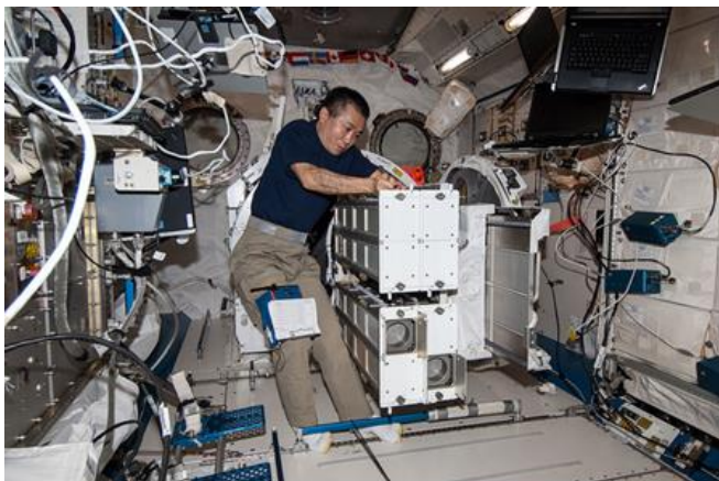
図4.1.1-19 NanoRacks社のCubeSat放出機構(NRCS)を「きぼう」エアロックのスライドテーブルに設置する若田宇宙飛行士3UサイズのCubeSat 16機(48U相当)を放出できます。
