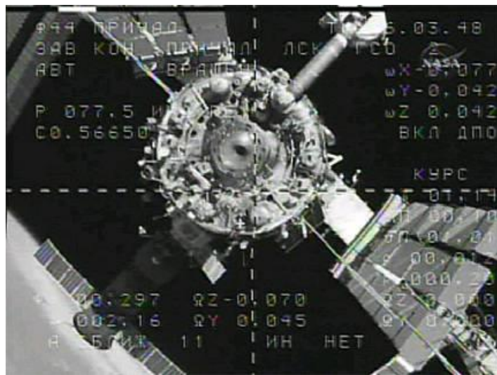
図2.4-1 ドッキング時の映像(カメラ映像にKursからのデータを重ねて表示)
