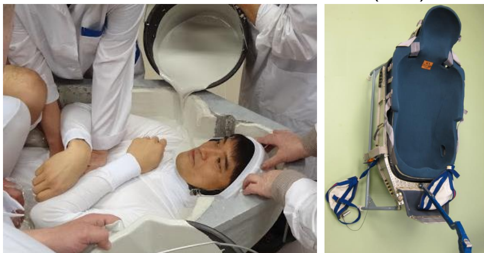
図2.9-2 (左)大西宇宙飛行士のシートライナーを石膏で型とりする様子 (JAXA)
