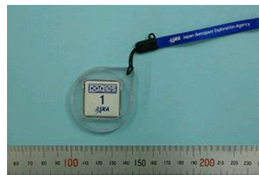
図4.1.1-30 JAXAが開発したCrewPADLES(受動式線量計) これを常に携帯します
