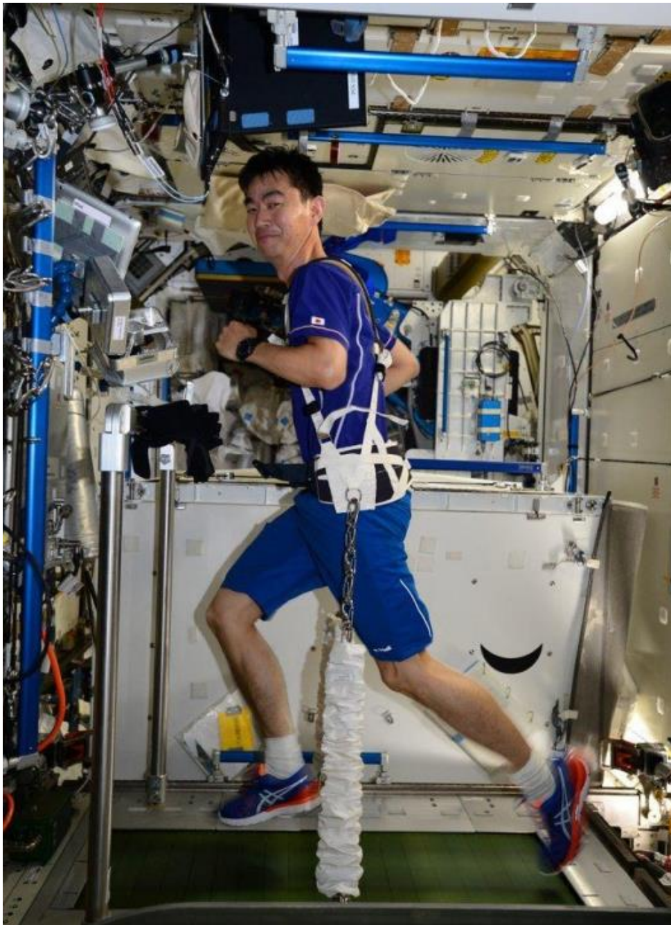
図3.3-2 ノード3内に設置されたT2「COLBERT（コルベア）」を使ったエクササイズ（JAXA） （※ゴム製のひもで体をトレッドミルに押しつけます）
