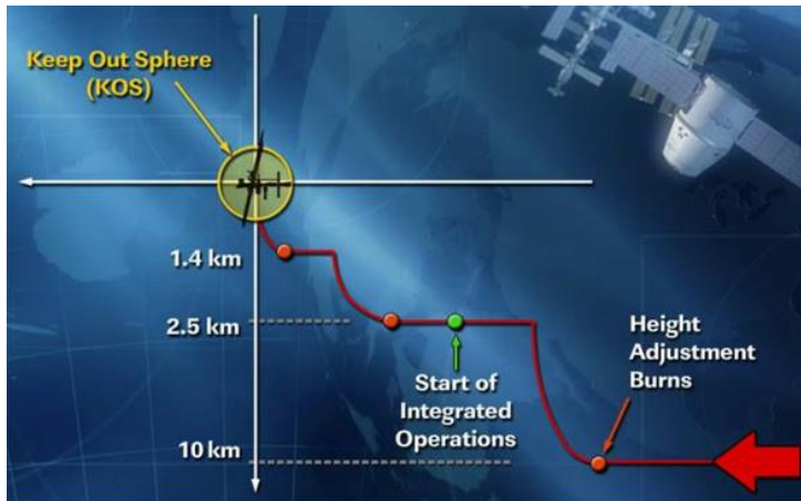
図4.3-3 ドラゴン補給船がISSに接近する方法 (NASA)
