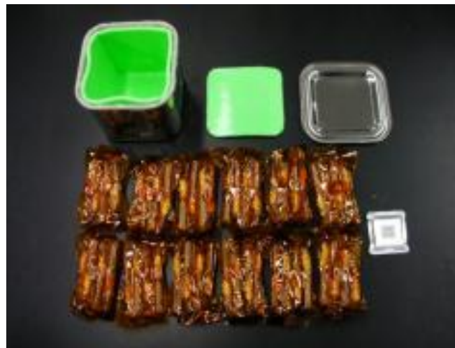
図4.1.1-36 宇宙実験でマウスの精子を保存するのに使用するアンプル（上図）。アンプルは下図の写真のようにカプトンテープで保護してケースに収納します。(JAXA)
