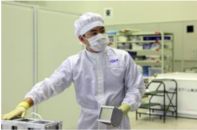
図4.1.1-18 CubeSat (星出宇宙飛行士が手に持っているのが1UサイズのCubeSat)
