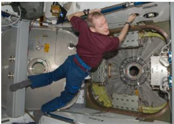
図4.3-7 (上図) 「このとり」到着時の共通結合機構の位置調整作業 (右は、ハーモニーの窓に位置決め用に設置するCBCS (Centerline Berthing Camera System)から撮影した映像。)
