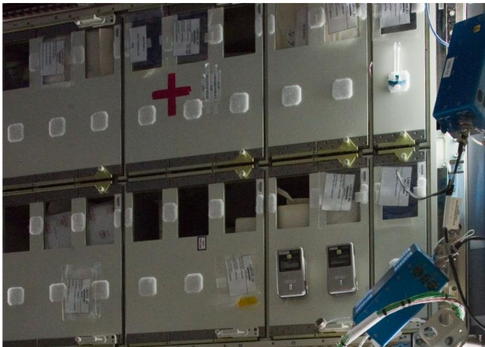
図3.3-7 デスティニー内のクーラー健康管理システムラック(CHeCS2ラック) (NASA)
