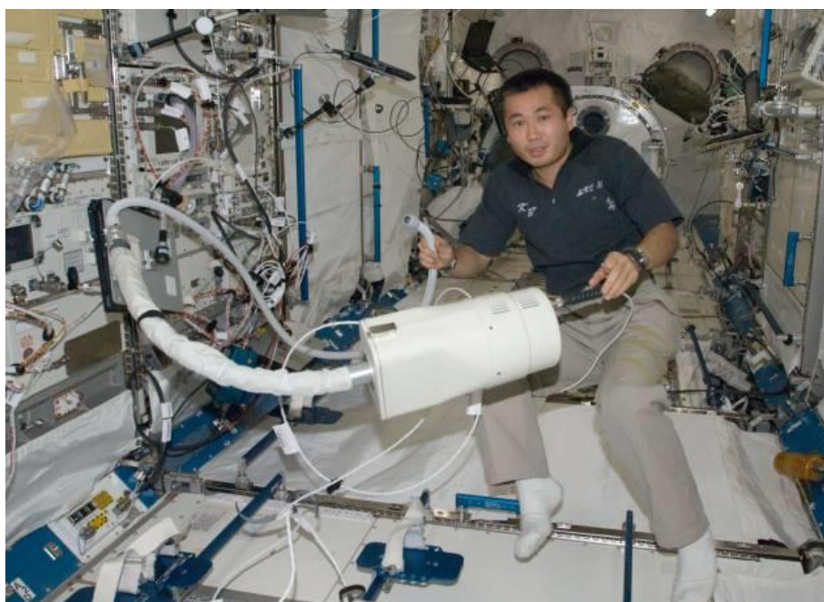
図4.2-3 「きぼう」の船内で掃除機をかける若田宇宙飛行士 (中央の白い円筒が掃除機本体、右手に持っているのが吸い込みノズル)
