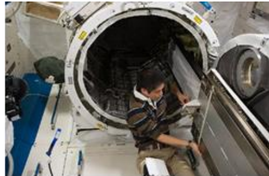
超小型衛星の放出準備のために、きぼうエアロックのスライドテーブルの作業を行う大西宇宙飛行士
