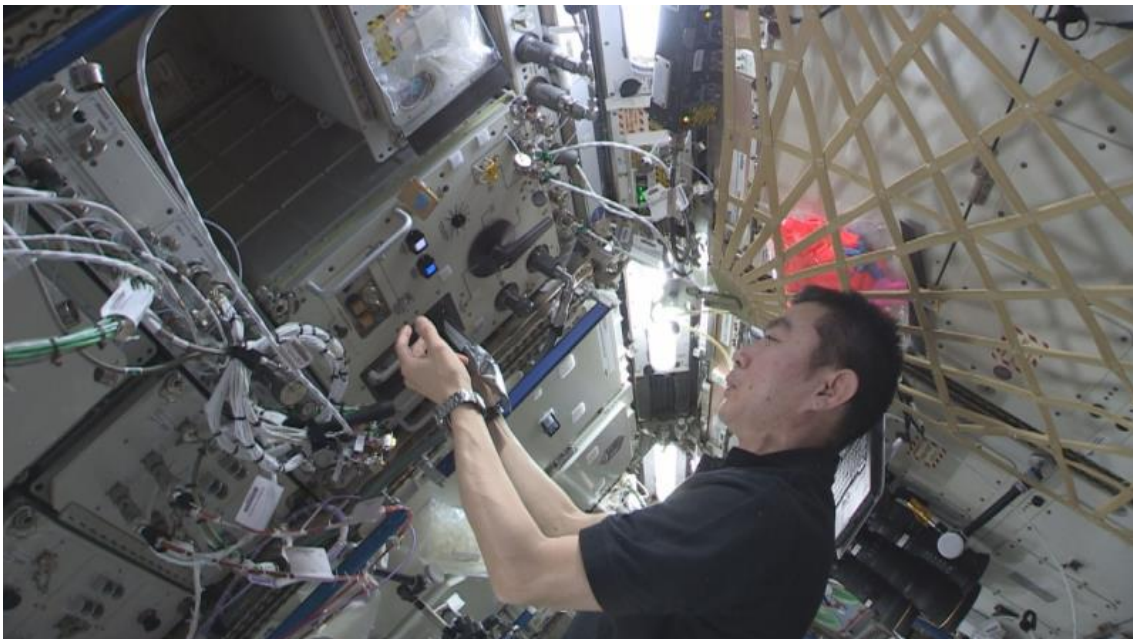
図3.2-4 飲料水供給装置を使う野口／油井宇宙飛行士 (JAXA) (上はロシアの機器、下は米国の機器)
