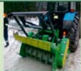
Фреза (дробилка) с неподвижными зубьями RS-15
