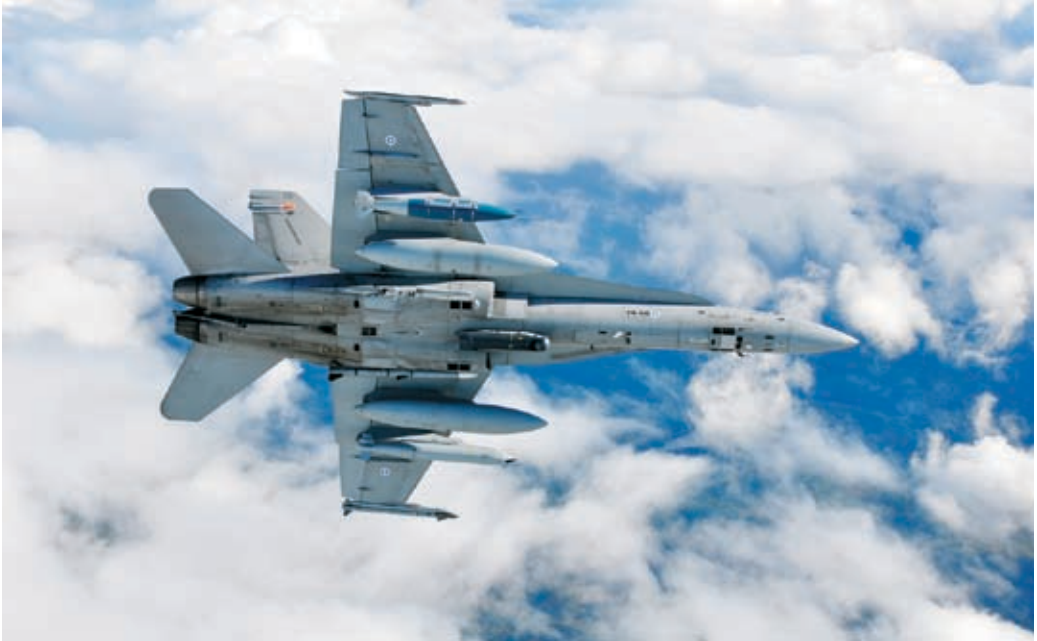
F/A-18 Hornet ilmasta maahan -varustuksessa. Oikean siiven ulommassa ripustimessa on ohjautuva JDAM-pommi, sisemässä ripustimessa lisäpolttoainesäiliö. Rungon keskilinjalla LITENING-maalinsintäsäiliö Vasemman siiven varustus sisäripustimesta kärkiripustimeen: AMRAAM-tutkahjus, lisäpolttoainesäiliö, JSOW-liitopommi ja AIM-9X-infrapunaohjus. Ilmavoimat, kuva: Ville Tuokko.
