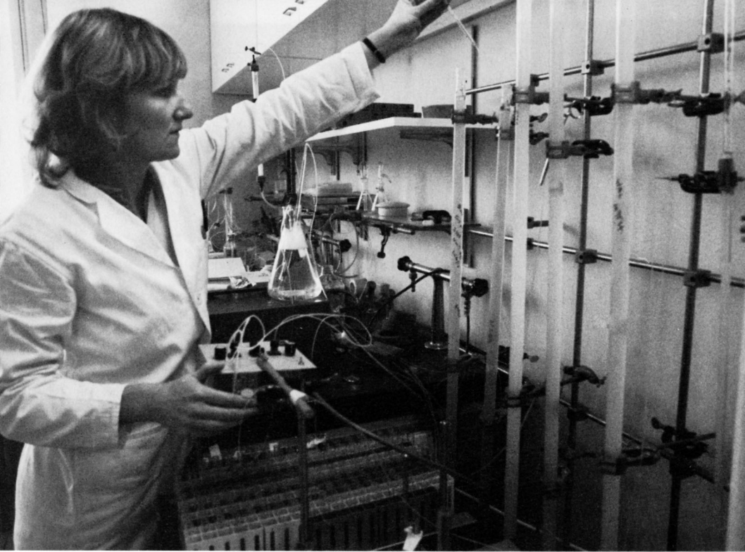
Das OmpA-Protein – ein Protein der äußeren Membran von Escherichia coli – wird durch Chromatographie auf Säulen auf diesem Bild von Cornelia Krämer gereinigt. Die Säulen sind mit einem Gel gefüllt, das Proteine entsprechend ihrer Größe auftrennt.
