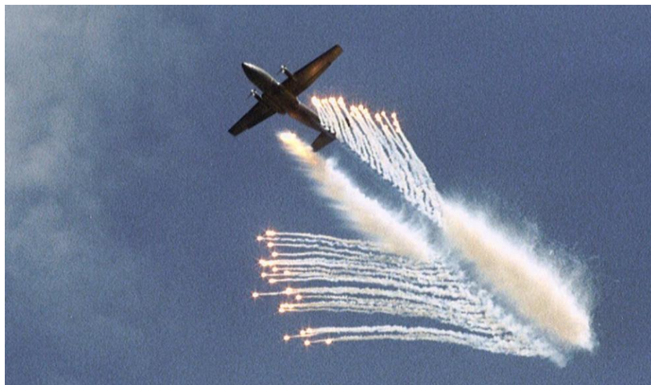
Abb.: TRANSALL mit IR-Täuschkörper zur Abwehr von Boden/Luft-Raketen
