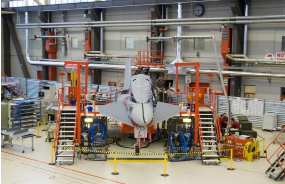
Abb.: Kooperation Zelleninstandsetzung EUROFIGHTER
