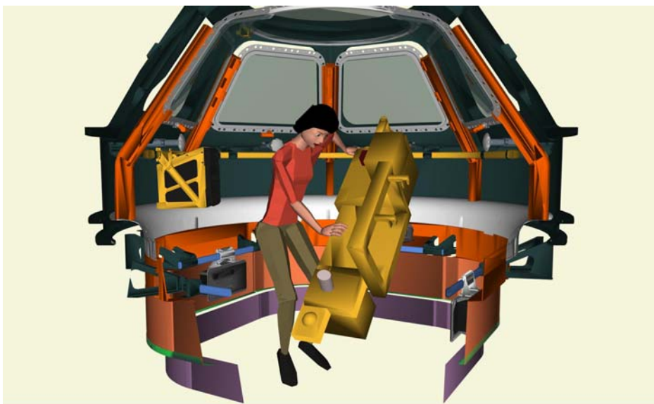
Bild 2. Exempel på bild från analyserna med datormanikin. En 5%ile Japansk kvinna hanterar och monterar den enhet (Robotic Workstation) som ska användas för att styra en robotarm på utsidan av rymdstationen.
