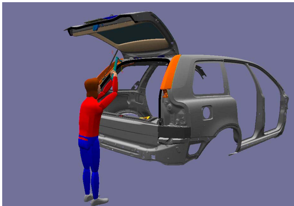
Bild 1. En datormanikin används vid simulering av montering. (Bild Volvo Cars)
