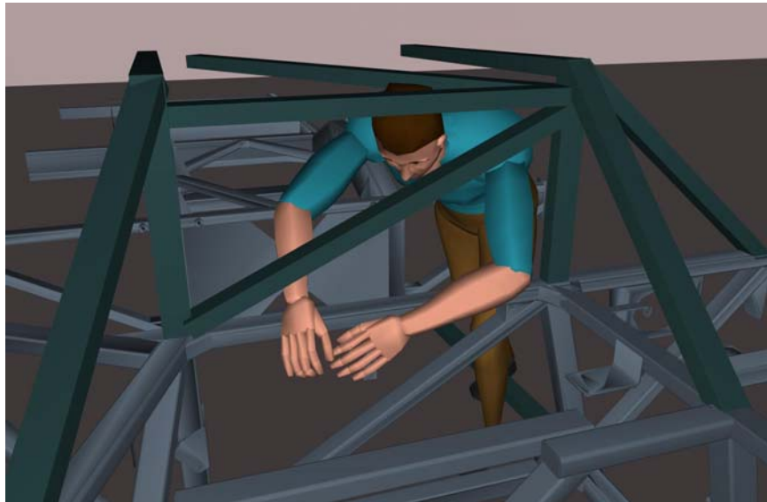
Bild 1. En monteringssituation där en balk skymmer sikten för montören.
