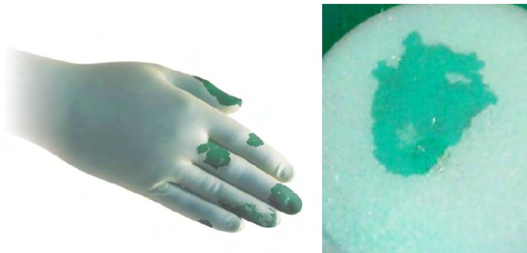
Abbildung 1: Doppelhandschuh-Indikatorsysteme (hier: Biogel® Eclipse™ Indicator™ von Mölnlycke) machen Perforationen erkennbar; defekte Handschuhe können sofort gewechselt werden.
