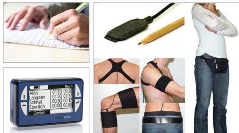
Abb. 1: Eingesetzte Methoden der Bewegungserfassung: Selbstberichtetes Aktivitätsverhalten (links oben), Ein-Sensor-Bewegungserfassung mit dem AiperMotion 320 (links unten) und Multi-Sensor-Bewegungserfassung mit dem CUELA Activity System (rechts).
