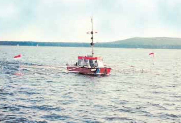
Abb. 4: Einsatz des Flächenecholotverfahrens
