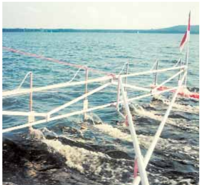
Abb. 5: Ausleger mit den Einzelloten (im Einsatz)
