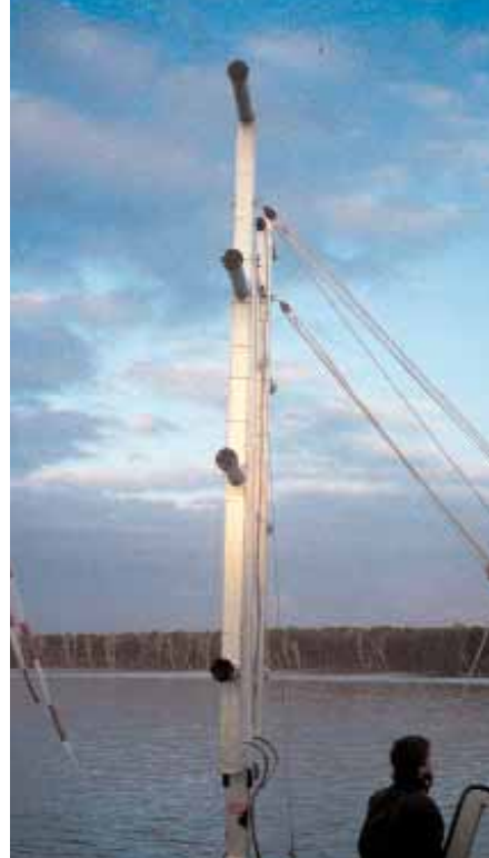
Abb. 6: Hochgeklappter Ausleger des Flächenecholotsystems
