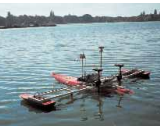
Abb. 8: Vermessung des Großen Zuges mit dem ferngesteuerten Katamaran
