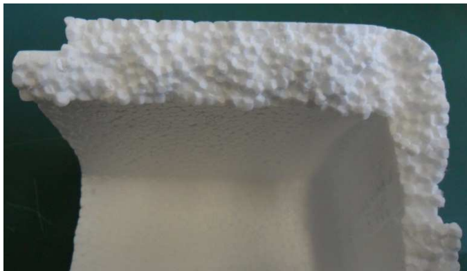
Abbildung 6: Untypischer Bruch durch einen Polystyrolschaum aus EPS. Die einzelnen verschweißten Partikel sind deutlich zu erkennen; Quelle: eigenes Bild.
