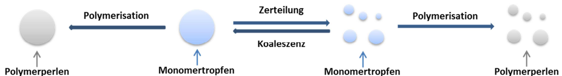
Schema 3: Durch Zerteilung und Koaleszenz der dispergierten Styroltropfen während der Polymerisation entsteht eine Größenverteilung der Polymerperlen.
