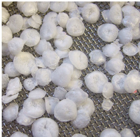
Abbildung 16: Vorgesäumte Schaumpartikel nach Methode B; Quelle: eigenes Bild.
