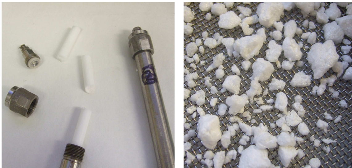
Abbildung 13: Links: die verwendeten Metallrohre und die darin entstandenen pentan- und additivhaltigen Polystyrolstangen; rechts: vorgeschäumte Schaumpartikel. Trotz vorheriger Siebung des ungeschäumten Granulats fallen Größe und Form äußerst unterschiedlich aus; Quelle: eigene Bilder.
