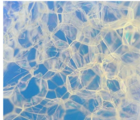
Abbildung 3: Styropor® in 200-facher Vergrößerung. Quelle: Urheber Jan Homann, gemeinfrei.
