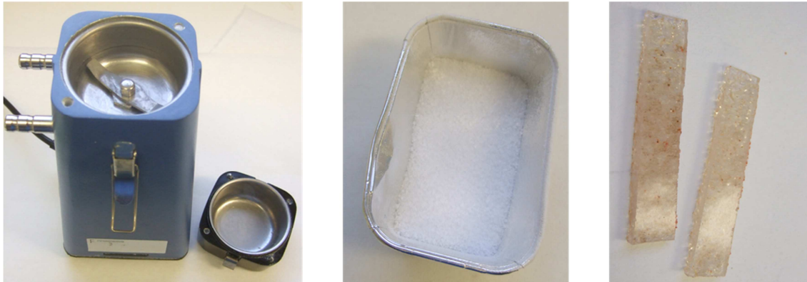
Abbildung 12: Von links nach rechts: die verwendete Labormühle zum Mischen der Proben; Aluminiumschale mit Additiv-Polystyrolmischung; fertige Prüfkörper; Quelle: eigene Bilder.
