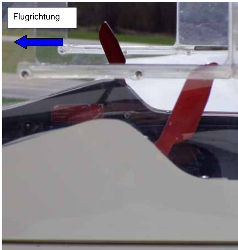
Abb.: Linker HVH (im Hintergrund) in Stellung „Entriegelt“, rechter HVH systembedingt ebenfalls in Stellung „Entriegelt“.
