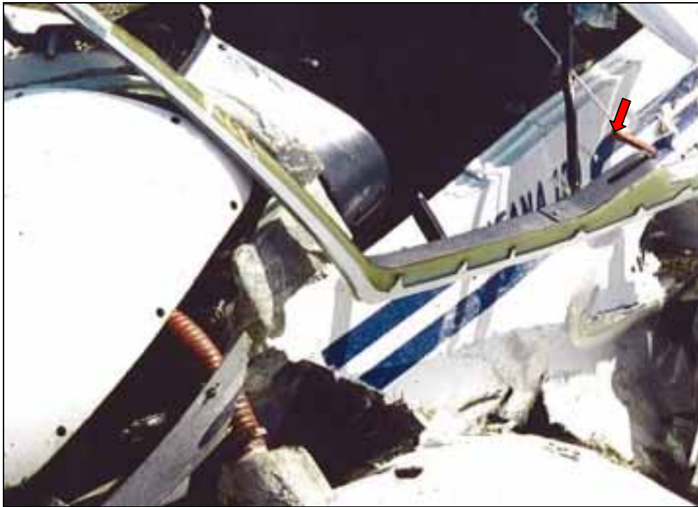
Abb.: Linker Haubenverschlusshebel (HVH), ca. 90° nach innen und unten gebogen, nach links verschobener Haubenrahmen
