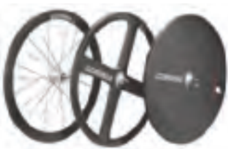
Ruedas de radios convencionales, de bastón y lenticulares
