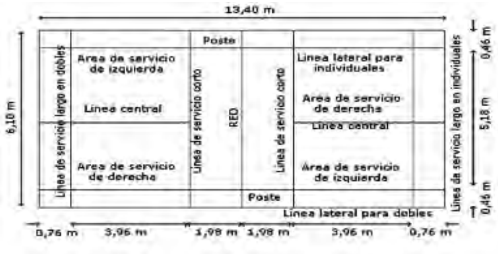
Fig. 2. Dimensiones oficiales de la pista de bádminton
