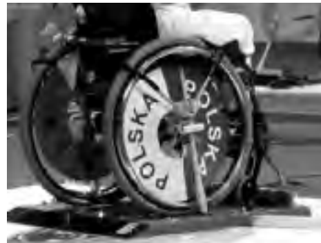
Arriba, detalle de la fijación de la silla Abajo, aparato de fijación de las sillas (Handi-Fix)
