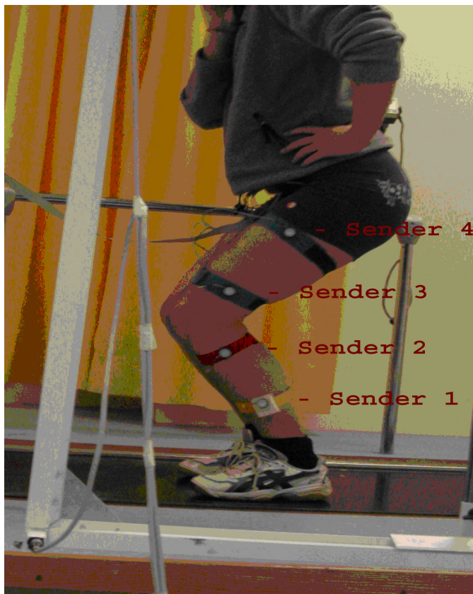
Abb. 13b: Senderanordnung bei der Kniebeuge
