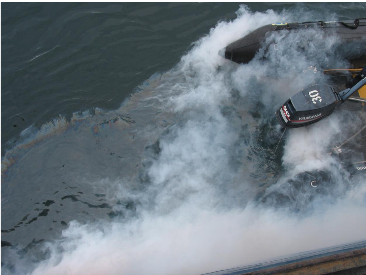
Abbildung 11: Ölfilm auf der Wasseroberfläche und Rauchabgase einer veralteten Diesel-Außenbordmotortechnik an einem Zodiac im Kaltstart in der Antarktis
