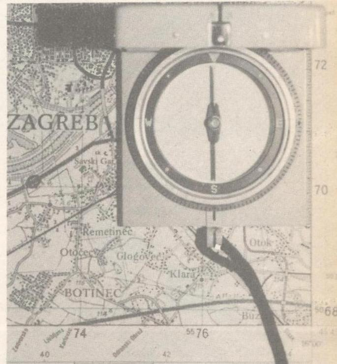
Na sličan način stajna točka se može odrediti — ucrtati viziranjem unazad od markantnih objekata, odnosno ucrtavanjem azimutnih smjerova od markantnih objekata na stajnu točku. (Azimut je kut između smjera sjevera i smjera na neki objekt i objašnjava se u idućem tekstu).
