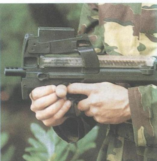
*U stalnoj potrazi za streljivom boljih balističkih osobina, konstruktori nude sve avangardnija rješenja. Na slikama je prikazana belgijska strojnica P90 i novi metak u kalibru 5,7 x 28 mm*
