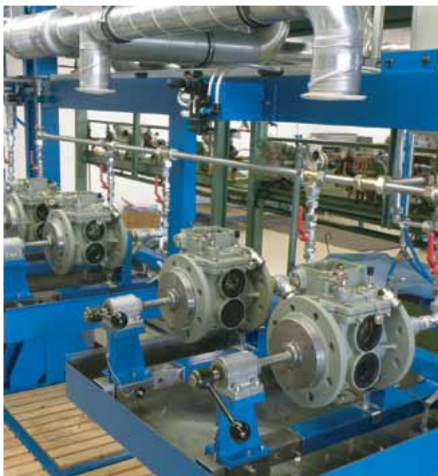
Figura 10 - Prueba funcional y de hermeticidad
