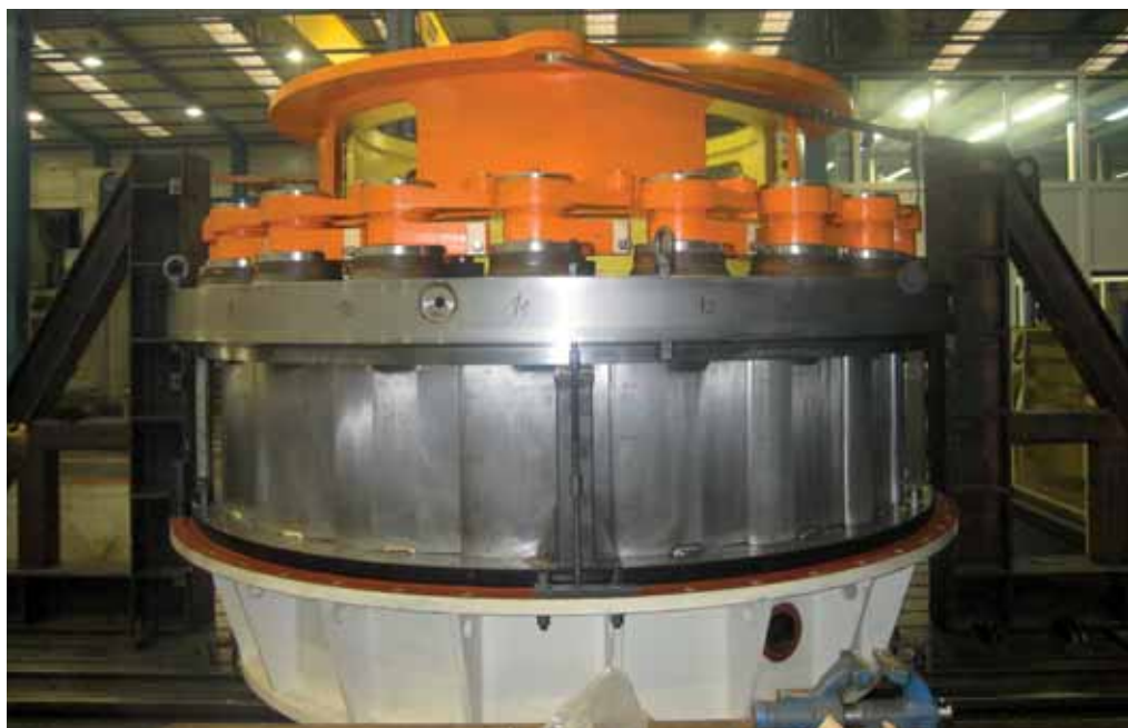
▲ Neue Turbine für das Wasserkraftwerk Ruacana, Namibia
