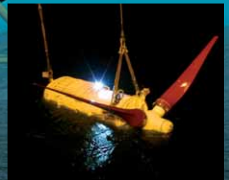
▲ Installation der HS1000 Maschinengondel
