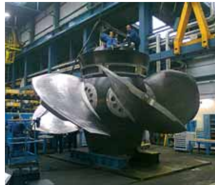
▲ Montage eines Kaplan-Turbinenlaufrads
