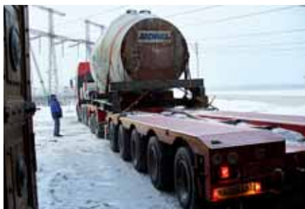
▼ Transport eines Kaplan-Turbinenlaufrads
