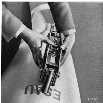
Abb. 37: Schließen der Traghaken
