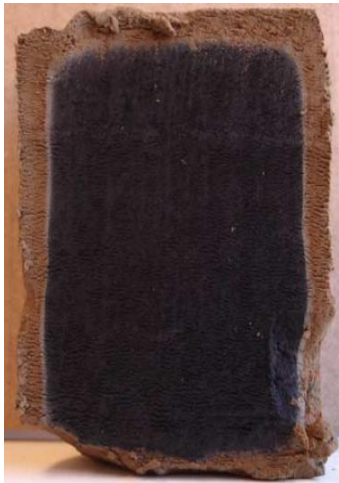
Kuva 3. Häiriintymätön sulfidimaanäyte (Pousette 2007).
