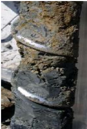
Kuva 4. Kairattu sulfidimaanäyte (Pousette 2007).
