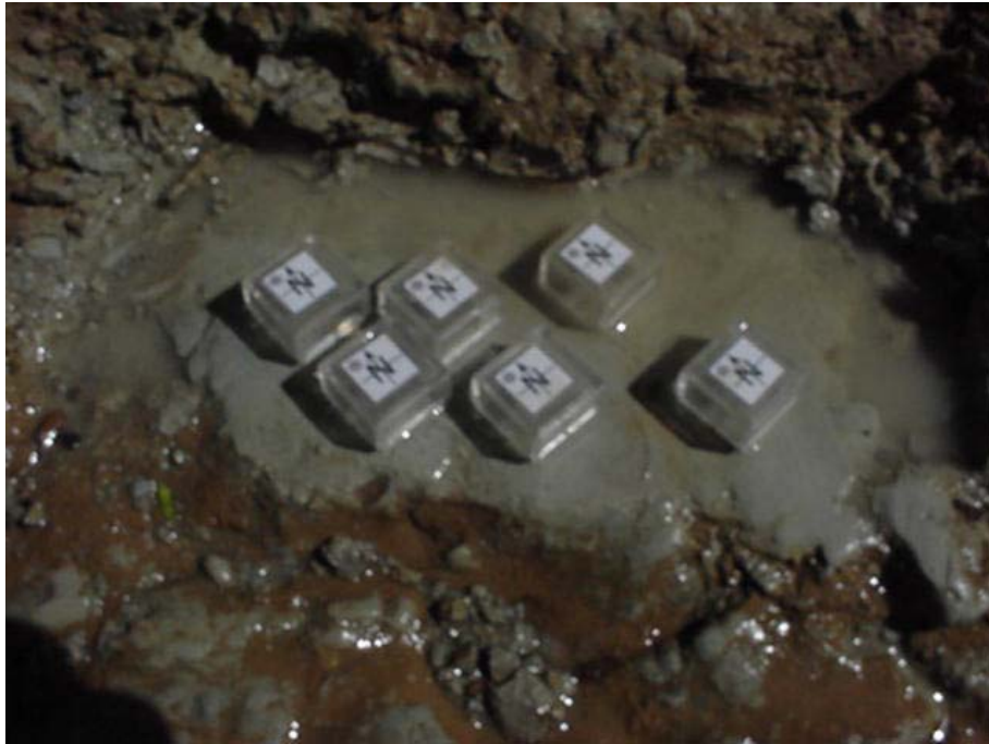
Imagen 3: Detalle que presenta el plano subhorizontal definido con las muestras colocadas y orientadas con el Norte magnético.
