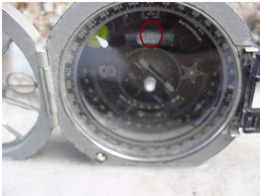
Imagen 2: Detalle que muestra la brújula Brunton calibrando el plano subhorizontal definido en la roca, nótese que el ojo de pescado se encuentra nivelado.
