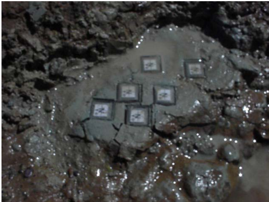
Imagen 3: Detalle que presenta el plano subhorizontal definido con las muestras colocadas y orientadas con el Norte magnético.
