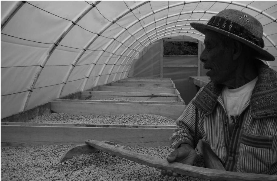
Fotografía 4 - Secadora solar manipuleo del café húmedo (M. Battaglia, IAO)
