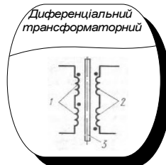
1 – збуджуючі обмотки; 2 – вимірювальні обмотки; 3 – ОК
