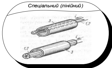
1 – збуджуюча котушка; 2 – вимірювальна котушка; 3 – ОК
