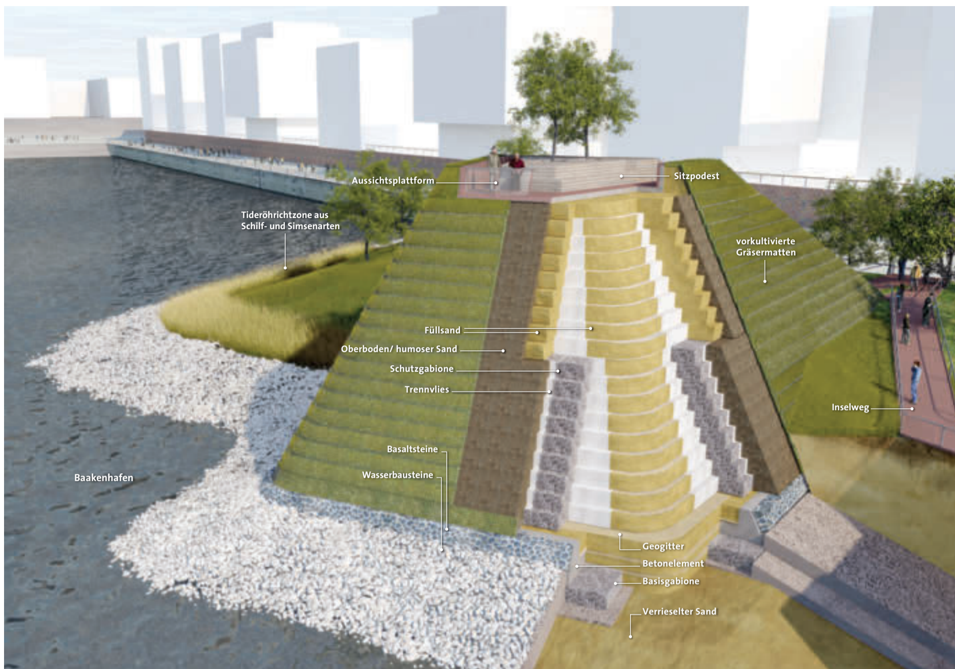
↑ Von außen sieht man nicht, was für eine raffinierte Konstruktion der Himmelsberg ist. Das Innere besteht aus mehreren Lagen an Füllsanden, die von Geogittern umschlossen werden. Wasserdurchlässige Trennvliese grenzen die unterschiedlichen Lagen voneinander ab. Am Fuß des Bergs befinden sich Elemente aus Stahlbeton und Basaltsteine. Auf 8,20 Metern ü. NN wurden zum Kollisionsschutz Steingabionen eingebaut. So bleiben im Schadenfall (z. B. durch den Anprall von Schiffen, Eis oder Treibgut) die darunterliegenden Lagen an Füllsanden intakt. An den steilen Außenseiten des Bergs wurden vorkultivierte Gräsermatten angelegt und mithilfe von Stahlgittern miteinander verhakht. Darunter liegen eingerieselte humose Sande (Informative Illustration: Christian Eisenberg)
