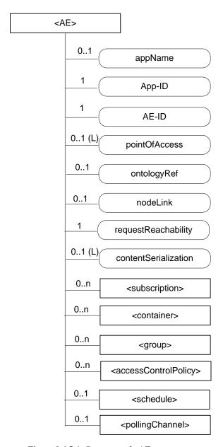
Figure 9.6.5-1: Structure of <AE> resource
