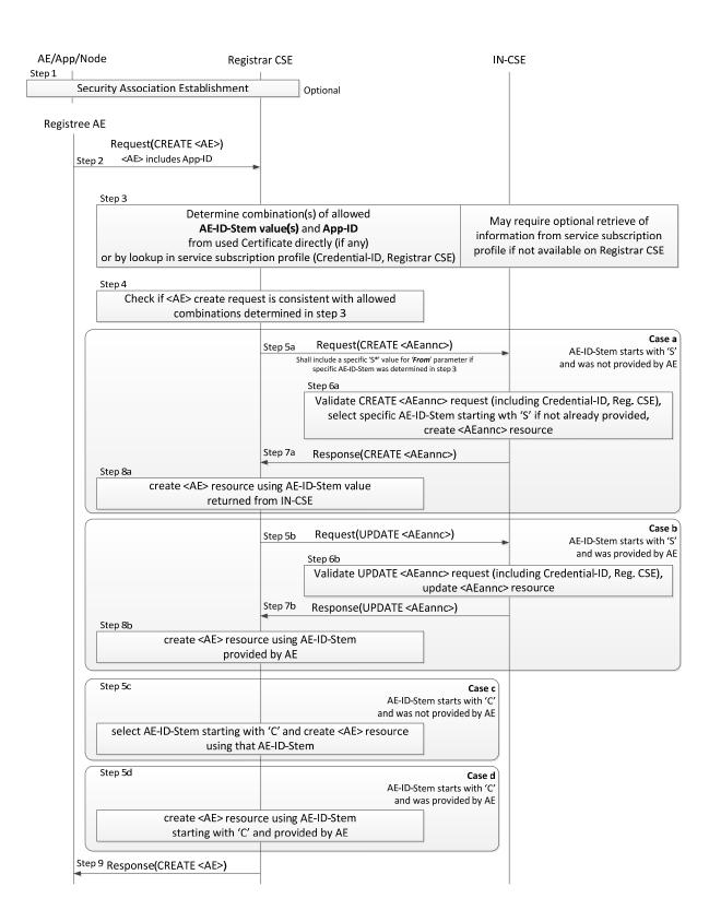
Figure 10.1.1.2.2-1: Procedure for Creating an <AE> Resource
