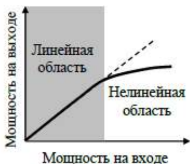
Рисунок 1 – Зависимость мощности на выходе световода от мощности на его входе
