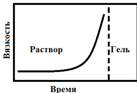
Рисунок 1. Типичная зависимость вязкости композиции СПС от времени в процессе гелеобразования.
