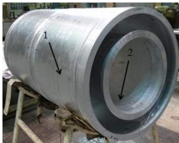
Рис. 2. Макетная конструкция сосуда давления толщиной 3 мм
