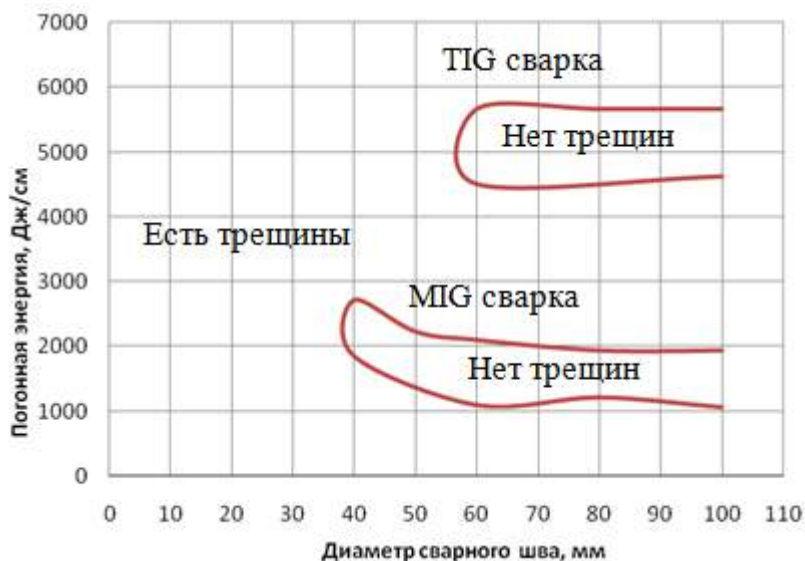
Рис. 3. Влияние погонной энергии и диаметра кругового шва на склонность к образованию горячих трещин в жестком закреплении для сплава 1151
