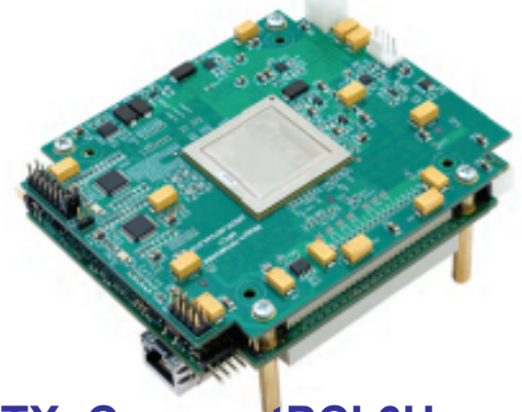
Модули в конструктивах: ATX, CompactPCI 6U, compactPCI 3U, COMExpress, PC/104
