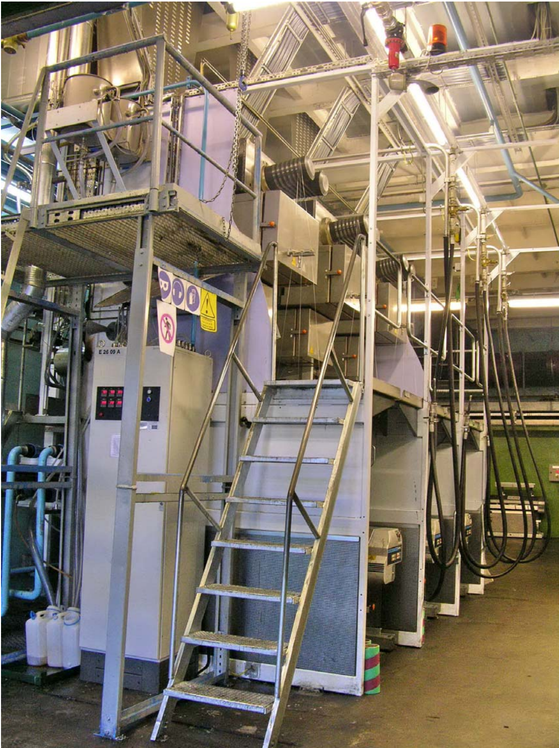
Намоточная часть машины получения полиэфирной высокомолекулярной малоусадочной нити
