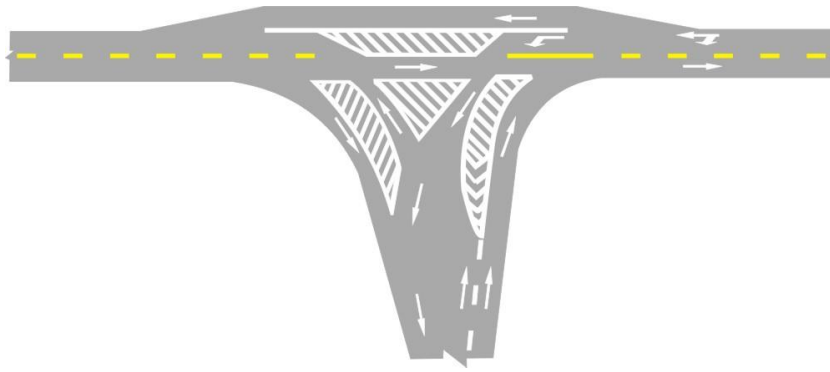
Hình G.30 - Bố trí vạch kênh hóa dòng xe ở ngã ba phức tạp – Mẫu 1
