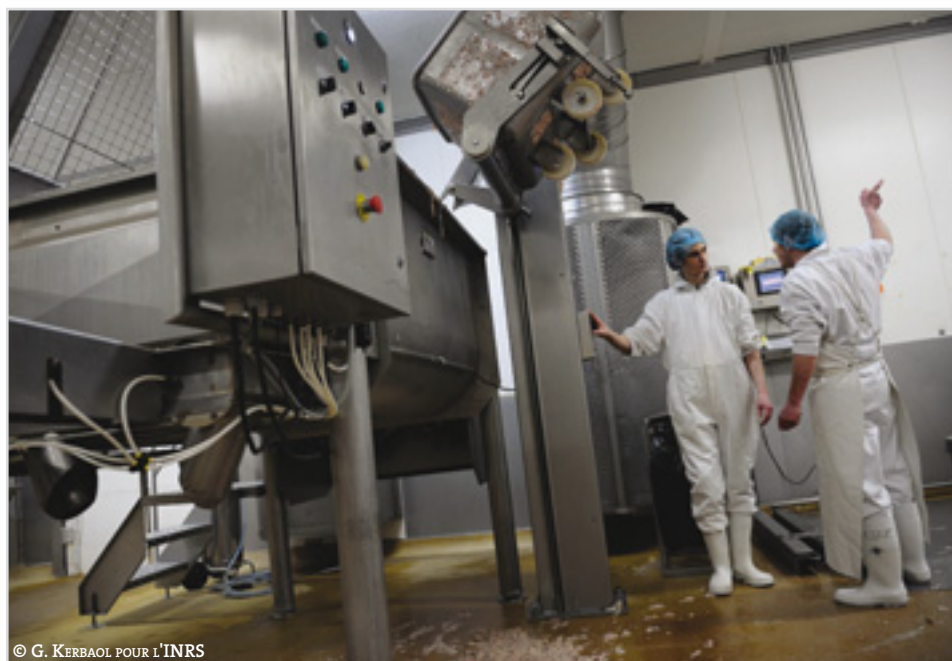
Incorporation des matières premières cuites dans un mélangeur pour une saucisse de porc.
