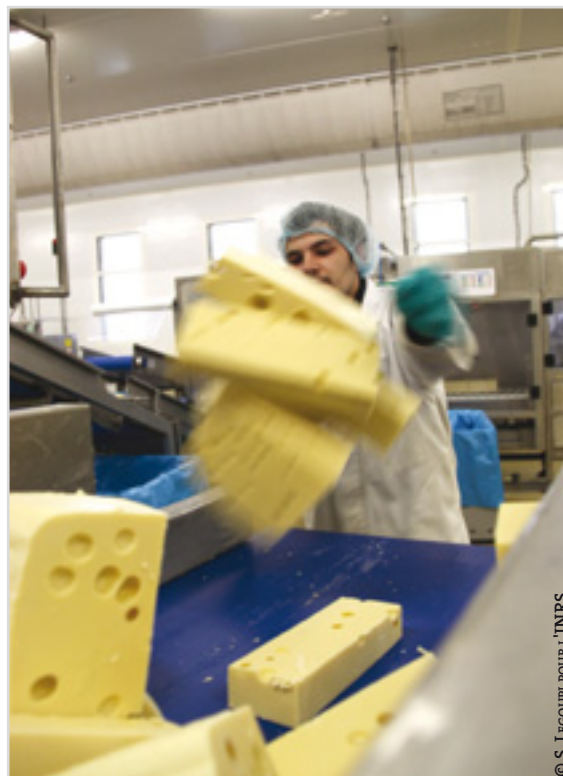
Transformation de produits laitiers : alimentation d'une ligne de fromage râpé.
