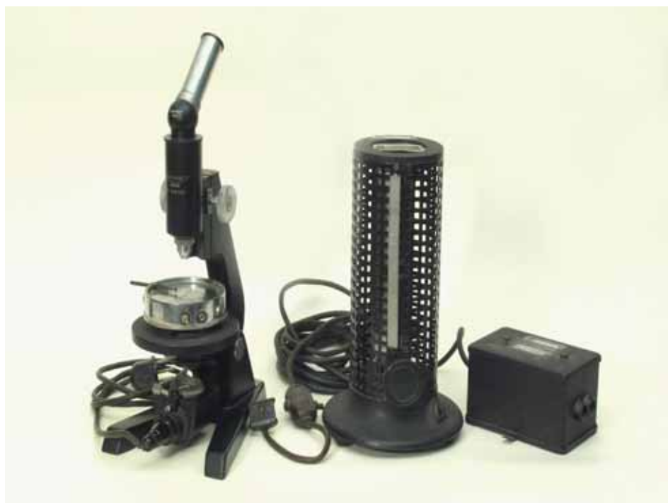
Apparecchio Kofler per la determinazione del punto di fusione al microscopio.
