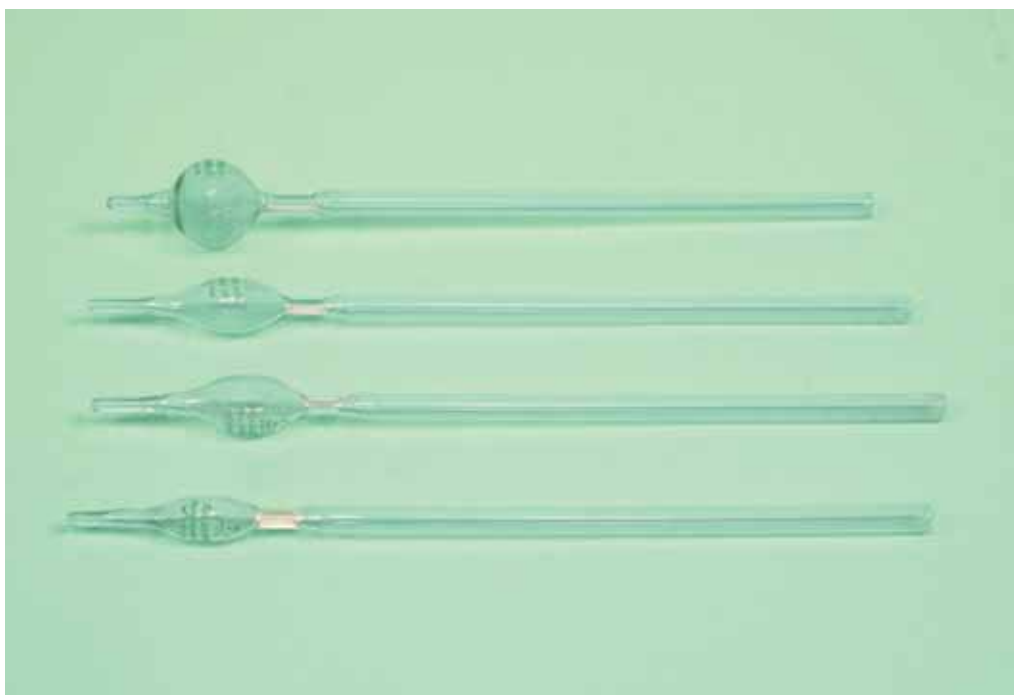
Micropipette di precisione secondo Pregl.
