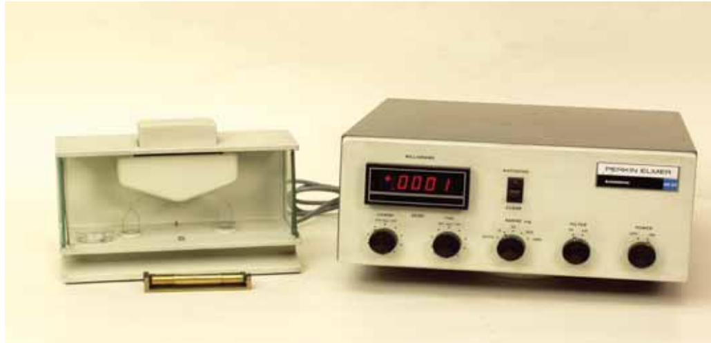
Ultramicrobilancia Perkin Elmer, anni 1965-1970.
