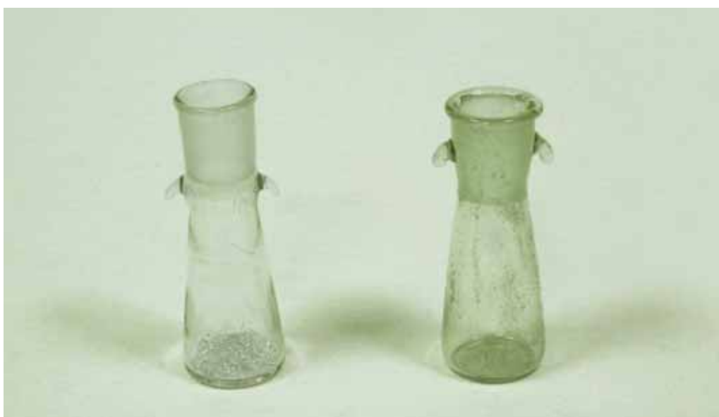
Recipienti per la decomposizione nella determinazione dello zolfo secondo Zimmermann.
