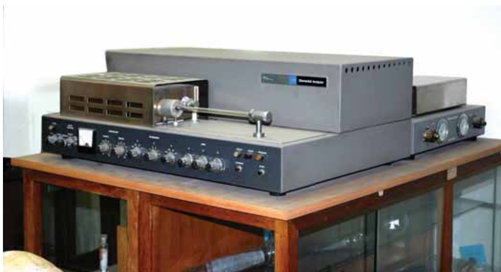
Apparecchio automatico Perkin Elmer 240 per la microdeterminazione simultanea di carbonio, idrogeno e azoto.
