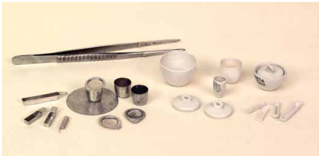
Crogioli e navicelle di platino e porcellana, pinze con punte di platino.
