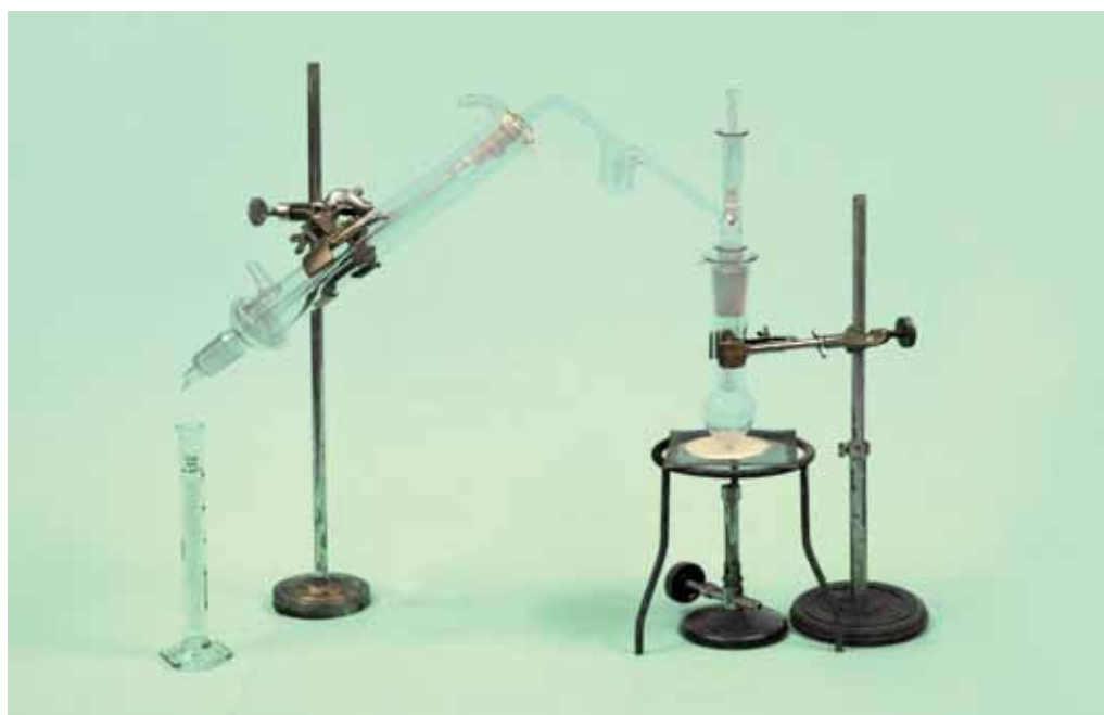
Apparecchio per la microdeterminazione del gruppo acetile e C-metile secondo Wiesenerger.
