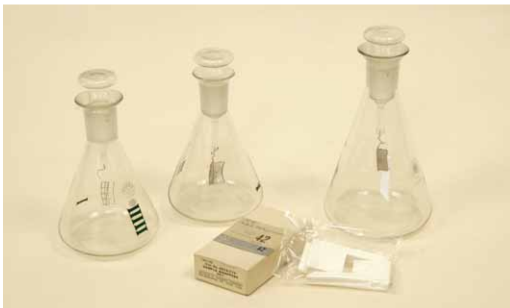
Beute di Schöniger per la combustione con cestello di platino, cartine speciali esenti da ceneri.
