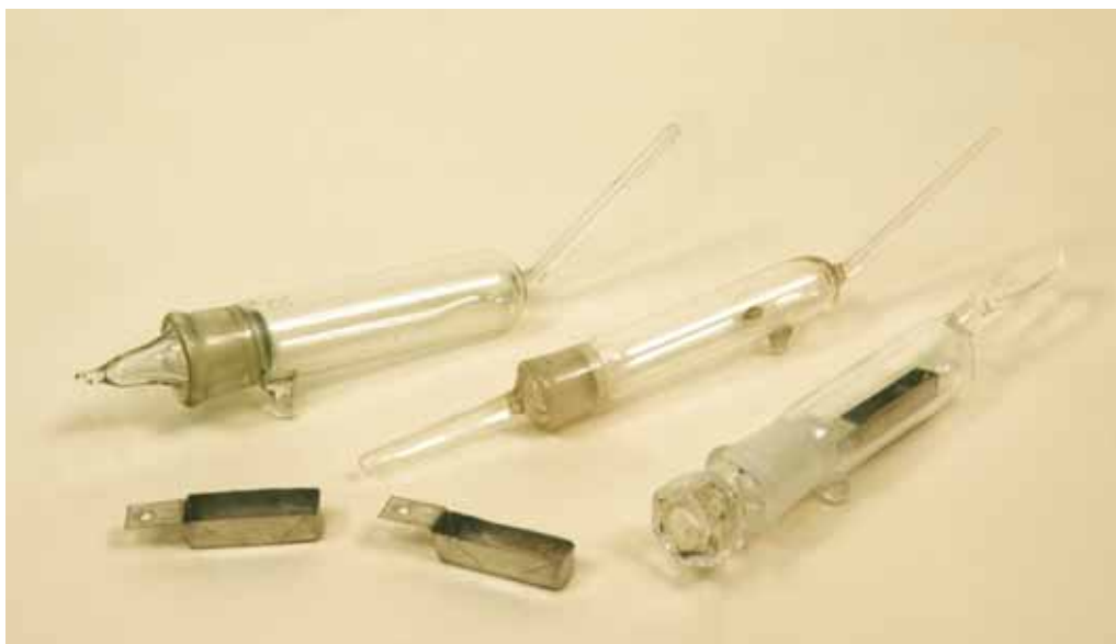
Porcellini per pesata di sostanze igroscopiche, navicelle di platino.
