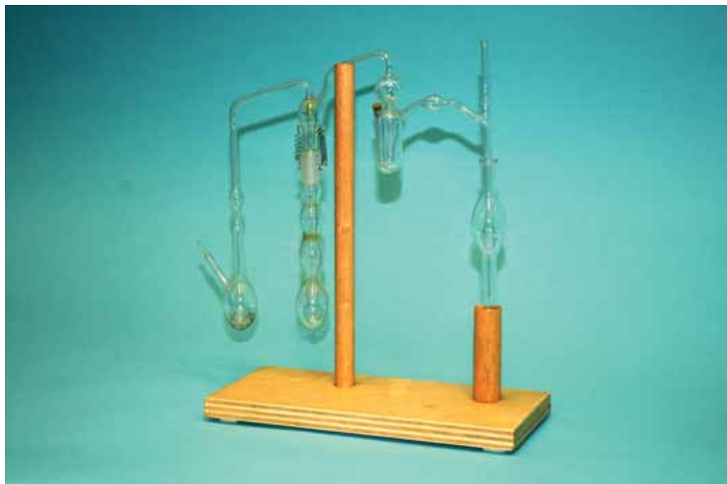
Apparecchio per la microdeterminazione dei gruppi metossilici.
