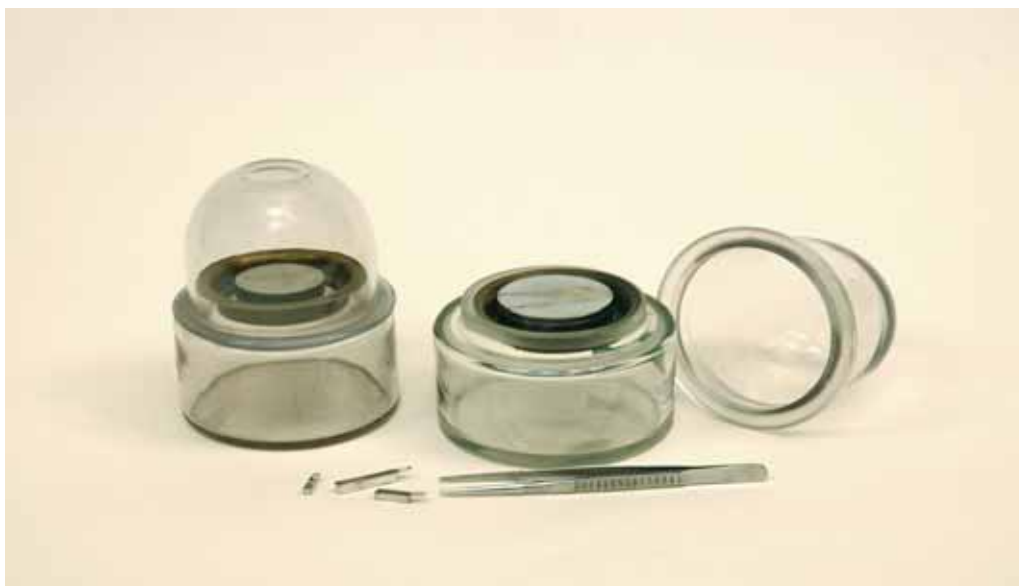
Essiccatore di Fresenius, navicelle di platino, pinze con punte di platino.
