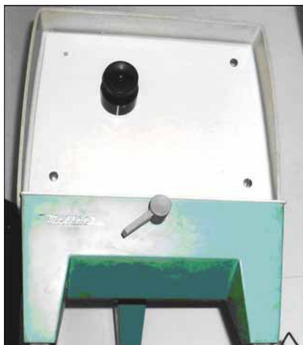
Ultramicrobilancia Mettler, anni 1970-1980.
