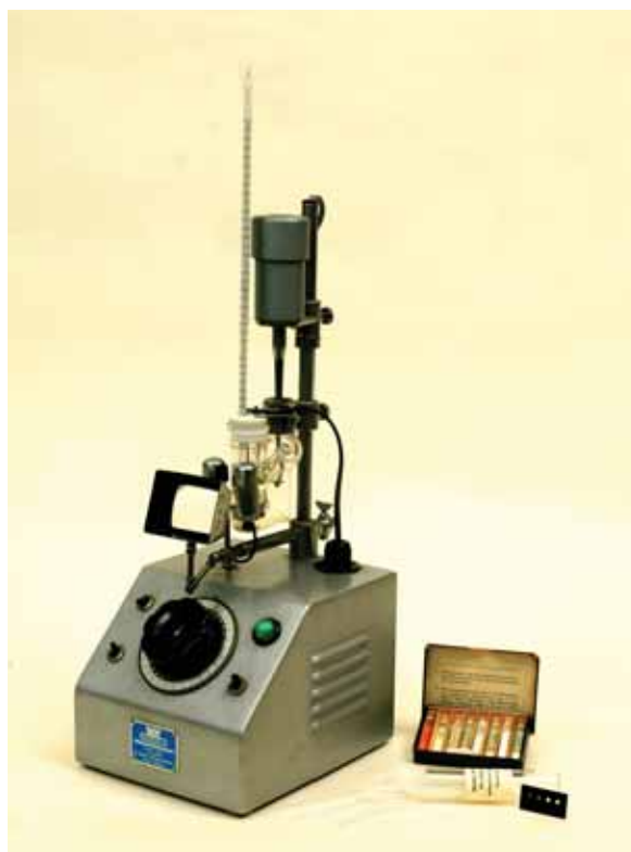
Apparecchio per la determinazione del punto di fusione nel tubo capillare e scatola con standard.
